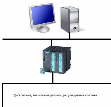
Рис.3. Структурная схема системы АСУТП мазутным хозяйством Костромской ГРЭС
