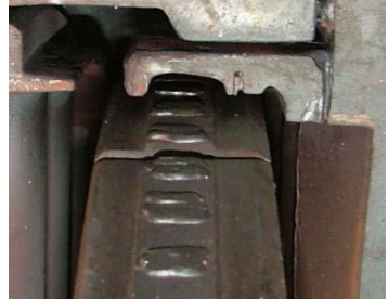
Рис. 2. Надбандажное радиальное уплотнение после задеваний
