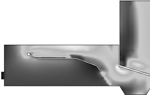
Рис.2. Пример визуализации поля скоростей (светлые области – области с более высокими скоростями дымовых газов)
