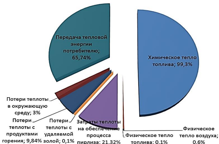
Рис. 2. Теплового баланса установки по переработке древесных отходов.
