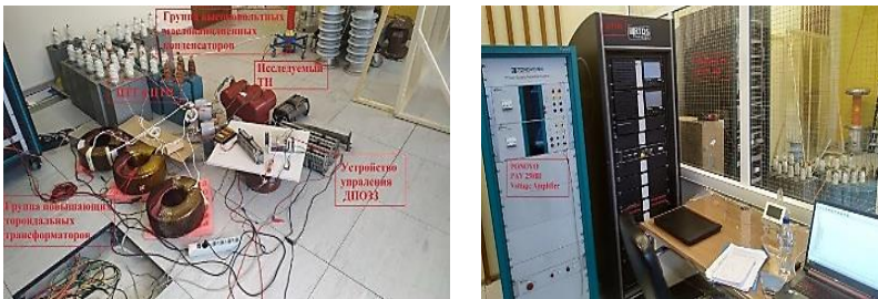
Рис. 2. Схема испытания трансформатора напряжения
