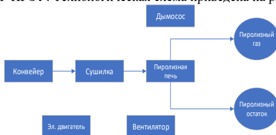
Рис.1 Технологическая схема пиролизной переработки ТКО
