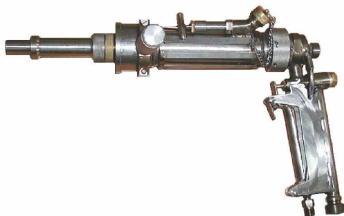
Рис. 2. Горелка ГВО-2М установки «Струмiнь» с сопловым блоком для напыления
