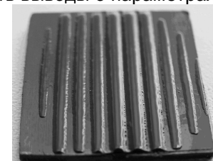
Рис. 1. Свободная поверхность магнитной жидкости, нанесенной на магнитоэластомерный элемент трения
