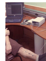
Рис. 1. Схема проведения эксперимента по исследованию динамических характеристик большеберцовой кости в естественных условиях
