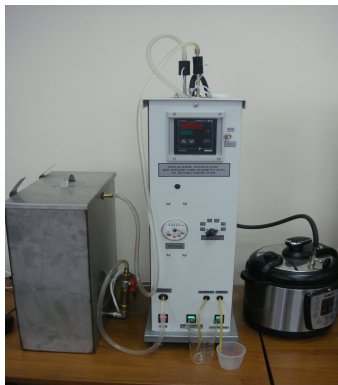
Рисунок 1 – Лабораторный стенд для определения степени сухости пара
