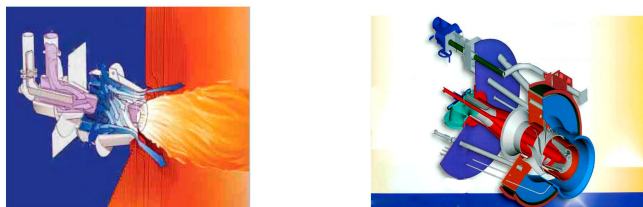
Рисунок 1 – Низкотоксичные пылеугольные горелки
