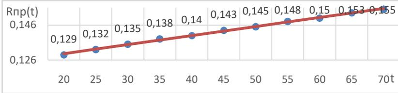
Рис.1. График зависимости сопротивления проводника от температуры
