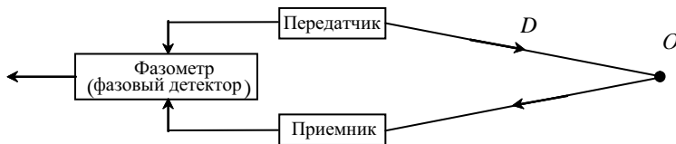
Рис. 1. Идеализированный пример применения фазового метода дальнометрии
