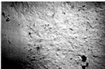
Рис. 1. Структура мартенсита, обработанная импульсным магнитным полем с использованием ферромагнитного порошка
