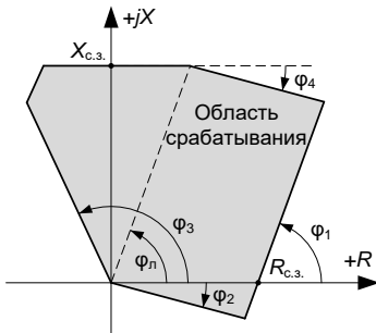
Рис. 1. Полигональная характеристика срабатывания ДЗ
