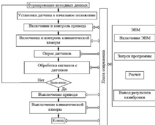
Рис. 2. Алгоритм калибровки гироскопа ВТГ
