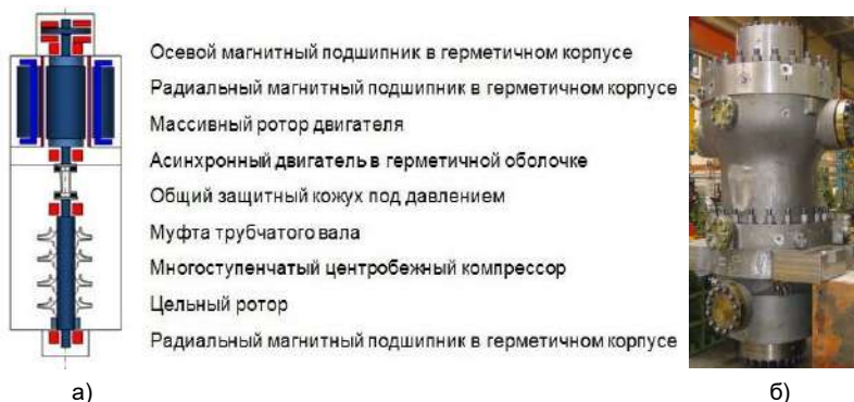
Рис. 2. Схема (а) и общий вид (б) ЭГПА вертикальной компоновки
