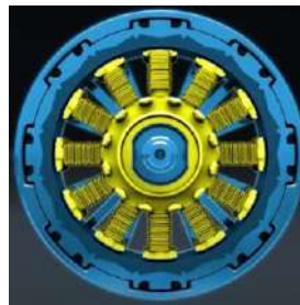
Рис. 4. Обращенный синхронный двигатель с магнитами на внешнем роторе и зубцовой обмоткой внутреннего статора
