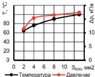
Рис. 3 Изменение критического давления и температуры МЖ в зависимости от объема заправки МЖГ
