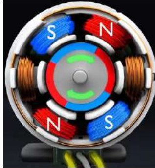
Рис. 2. Бесщёточный двигатель с поверхностным размещением магнитов на роторе
