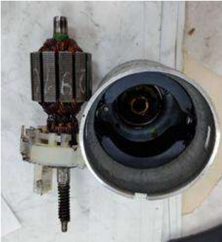
Рис. 1. Магнитоэлектрический электродвигатель моторредуктора постоянного тока
