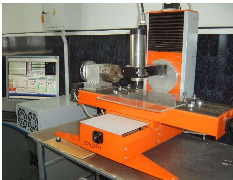
Рис. 1. Фрезерно-гравировальный станок Cutter FG 380x190x140
