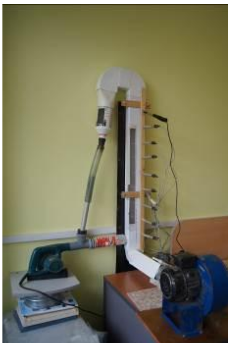
Лабораторная установка с циркуляционным кипящим слоем
